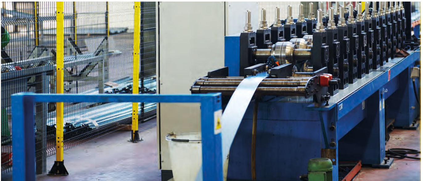
Profilatura lamiera per produzione strutture metalliche per porte. Profiling department for door metal trackset production.
